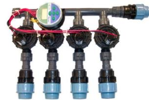
**Batteriebetriebenes Hybrid-Steuergerät, elektronisch, 3 Programme mit je 4 Startzeiten, Anschluss für Hauptventil, arbeitet mit Impuls-Magnetspulen (Latching-Solenoids), wetterfestes Gehäuse, Batterien (6 x AA) nicht im Lieferumfang**
