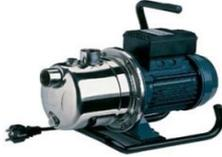
Horizontale, einstufige Kreiselpumpe, selbstansaugend, mit 1,5m Kabel und Schukostecker, max Saughöhe: 8m Betriebsdruck: 6bar; Spannung 230V/50Hz
