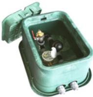
**Vormontierte Hauptventilstation, mit Filter, Hydrantanschluss, Druckluftanschluss zur Entleerung, Hunter Hauptventil mit Magnetspule 24Volt 50Hz, Durchflussmesser (QN 2,5) mit Impulsgeber für HC, PHC, HPC und HCC, Hauptabsperrhahn, einschl. Ventilboxboden, alle Anschlüsse 1" AG**
