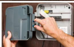
**Decodersystem für HPC wandelt ein HPC-Steuergerät in ein 2-Leiter Decodersystem um; reiner Decoderbetrieb bis zu 28 Stationen;**
