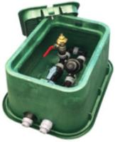
**Vormontierte Hauptventilstation, mit Filter, Hydrantanschluss, Druckluftanschluss zur Entleerung, Hunter Hauptventil mit Magnetspule 24Volt 50Hz, Hauptabsperrhahn, einschl. Ventilboxboden, alle Anschlüsse 1" AG**
