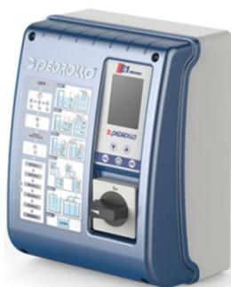
**Elektronische Steuerung für Pumpen**, dreiphasig, 400V 50 Hz, allgemeiner Lasttrennschalter, Sicherung des Hilfsstromkreises, Motorschutz-Sicherung, externes ABS-Gehäuse, Kabelverschraubungen, Schutzart IP 55, Umgebungstemperatur -5/+40 °C, Relative Luftfeuchtigkeit 50% bei 40 °C, (B, H, T 234 x 314 x 169mm)
