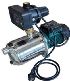
Vollautomatisches Hauswasserwerk Typ **CDEI**, besonders geeignet für Beregnungsanlagen. Automatisches Ein-/Ausschalten der Pumpe, Trockenlaufschutz, autom. Reset nach Trockenlauf, einstellbarer Einschaltdruck, Rückschlagventil, kompl. montiert und einsatzbereit. Förderstrom (Förderhöhe):
