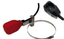
**Schwimmerschalter** als Wechsler, wahlweise zum Entleeren oder Befüllen, Schaltleistung max. 6A/250VoltAC mit freiem Kabelende. Zur Befestigung am Einlaufrohr oder an einer Unterwasserpumpe. Schalthebel und Schelle (110-130mm) aus V2A
