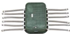
**Vormontierte Jumbo-Ventilstationen mit Schrägsitzventil als Hauptabspernung, Druckluftanschluss zur Entleerung im Winter, manuelles Entlastungsventil, HUNTER-PGV-101-Ventilen mit Standard-Magnetspulen 24Volt 50Hz, Durchflussregulierung an allen Ventilen,**
