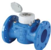
**Wasserzähler** (Trockenläufer) für Kaltwasser mit eingebautem Impulsgeber für waagerechten und senkrechten Einbau, mit Flansch.
