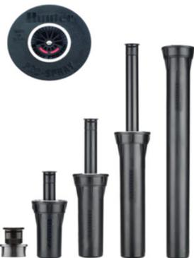
**Hunter Sprühdüsen-Gehäuse Serie PRO-SPRAY-PRS30; Anschluss 1/2" IG; eingebaute Druckregulierung 2,1 bar, max. Eingangsdruck: 6,9 bar;**
