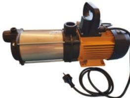
Horizontale, mehrstufige Kreiselpumpe, selbstansaugend, mit 1,5m Kabel und Schukostecker, max Saughöhe: 8m; Tragegriff; Schalter; Spannung 230V/50Hz
