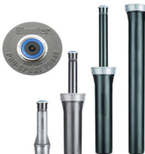
**Hunter Sprühdüsen-Gehäuse Serie PRO-SPRAY-PRS40; Anschluss 1/2" IG;****eingebaute Druckregulierung 2,80 bar, max. Eingangsdruck: 6,9 bar;
