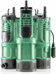
**Unterwasserpumpe/ Behälterpumpe mit 15m Netzkabel** und Schukostecker, integrierte Schalteinheit, zur Förderung aus Regentanks und Zisternen. Die integrierte Schalteinheit steuert die Ein- und Ausschaltung der Pumpe. Ein Trockenlaufschutz ist integriert sowie ein automatischer Reset. Spannung 230V/50Hz, Ausgang 1" Innengewinde, Volumenstrom/Fließdruck: 1,2m³/h/4,0bar; 1,8m³/h/3,7bar
