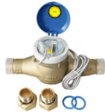
**Wasserzähler** (Trockenläufer) für Kaltwasser mit eingebautem Impulsgeber für waagerechten und senkrechten Einbau, einschl. Anschlussverschraubungen, Impuls verwendbar mit Steuergeräten vom Typ HC, PHC, HPC und HCC
