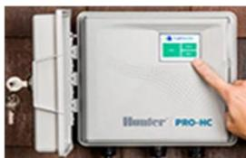
**Hunter Pro-HC Steuergerät mit Touchscreen-Oberfläche, 36 Startzeiten pro Tag, 36 Programme, maximale Stationslaufzeit 24 Stunden, Anschluss für Pumpenstart-Relais, Zugang über WLAN oder direkt am Gerät, Anschluss für 2 Sensoren (z.B. Regensensor und Durchflusssensor),**
