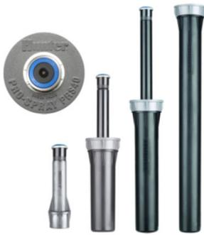
**Hunter Sprühdüsen-Gehäuse Serie PRO-SPRAY-PRS40; Anschluss 1/2" IG; eingebaute Druckregulierung 2,80 bar, max. Eingangsdruck: 6,9 bar; mit eingebautem Auslaufstopventil bei 04, 06 und 12**
